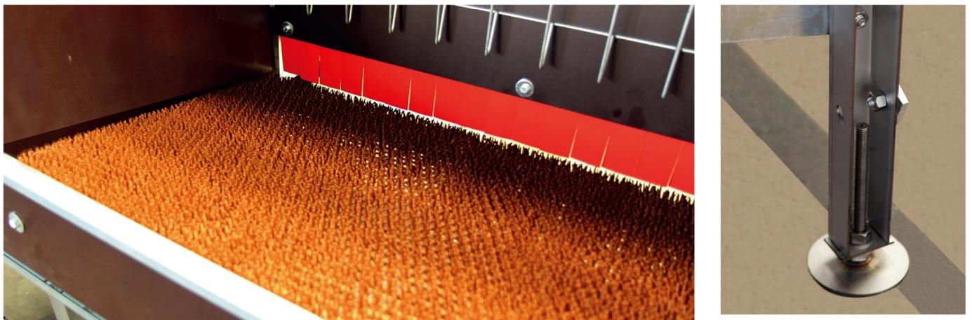
中央集蛋箱的隔板及許多其他組件，是採用樺木膠合板及酚醛樹脂開發而成，與想像不同的是，這種材料非常耐清洗，而且也能進行消毒操作。在結構上，金屬部分則是由鍍鋅鋼製成，並搭配不鏽鋼的支撐腳架，提高耐用性與堅固程度。所有金屬組件都是開放式設計，可有效避免細菌滋生。
